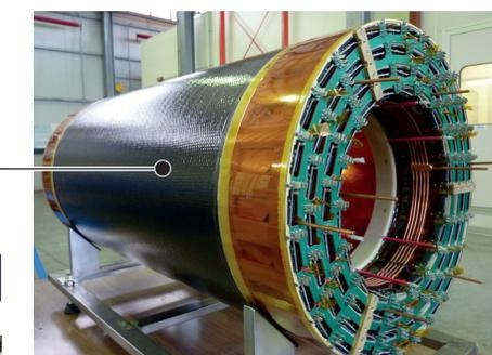
Il Tracciatore Interno è costituito da **4 rivelatori GEM**. La tecnica innovativa di costruzione di GEM cilindriche è stata sviluppata ai LNF.
